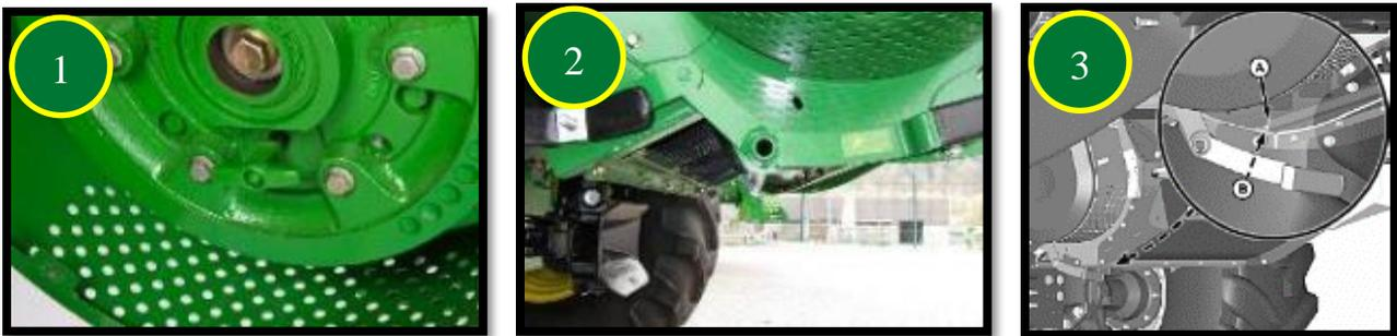
Le déflecteur de rafles n° 1 doit être en position relevée/petites céréales. Les ailettes du déflecteur arrière ou du volet de broyage/andainage n° 2 sont réglables afin d'améliorer la répartition des résidus.
