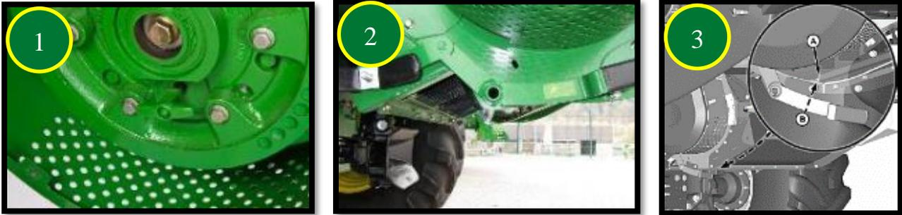
Le déflecteur de rafles n° 1 doit être en position relevée/céréales. Les ailettes du déflecteur arrière ou du volet de broyage/andainage n° 2 sont réglables afin d'améliorer la répartition des résidus.
