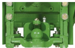
Insert d'attelage à rotule – AL225421
