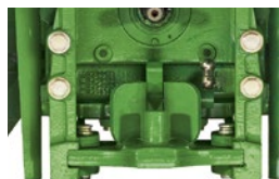
Insert d'attelage à piton – AL222367
